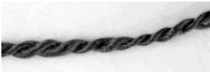
Roving di fibre di C ritorte
